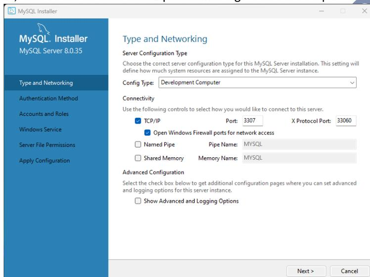
De base, MySQL utilise le port 3306. Ici, nous le configurons sur le port 3307 car je dispose, pour ma part, d'autres instances sur ma machine. « Next ».
